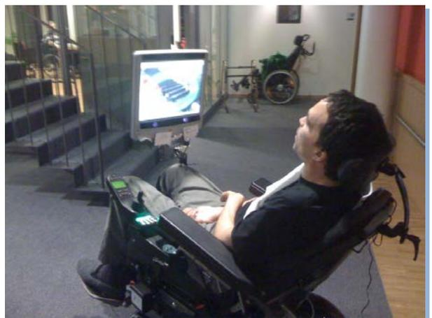
Le système de pilotage oculaire de l'ordinateur est monté directement sur le fauteuil à l'aide d'une fixation adaptée. Elle est prolongée en son extrémité par un bras, permettant de maintenir le système à bonne distance, entre 40 et 80 centimètres. L'arrière de l'écran est équipé d'une webcam. Elle permet d'afficher la vision avant de l'utilisateur à travers l'écran ; celui-ci est donc transparent.
